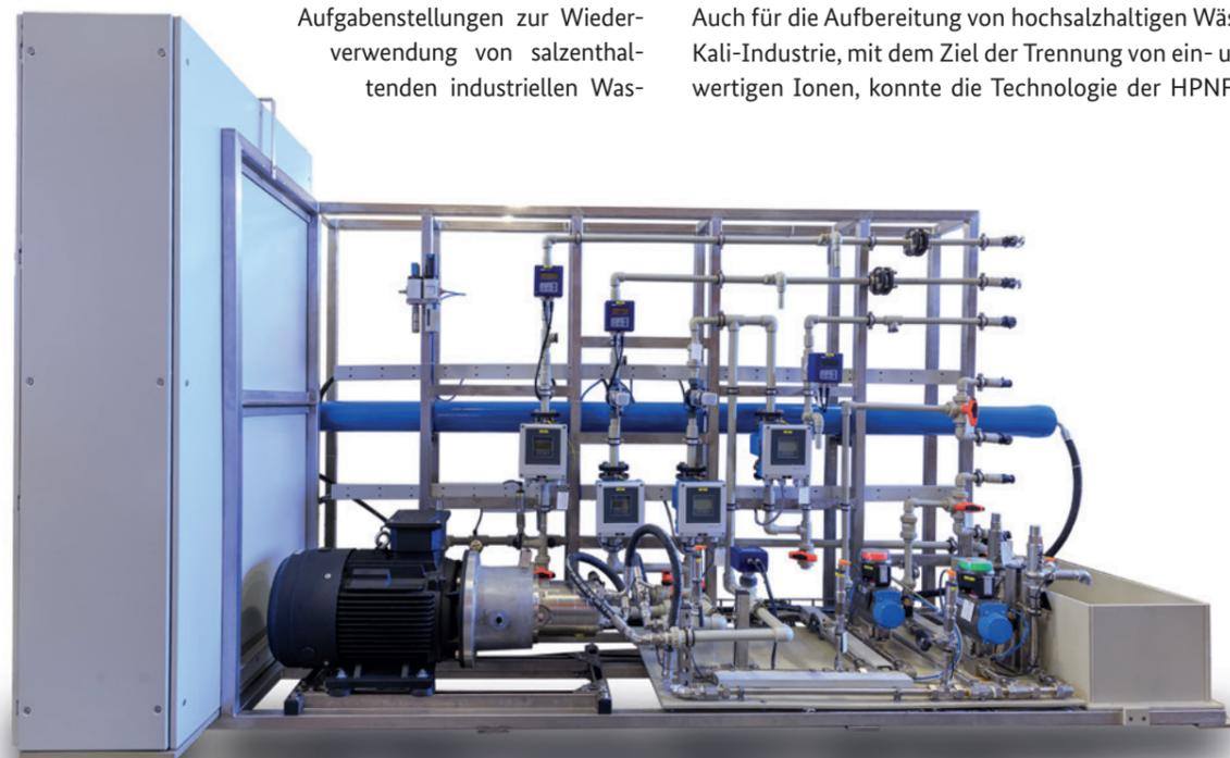
Hochdrucknanofiltrationsanlage für 120 bar Anwendung (Quelle: BWS Water).
