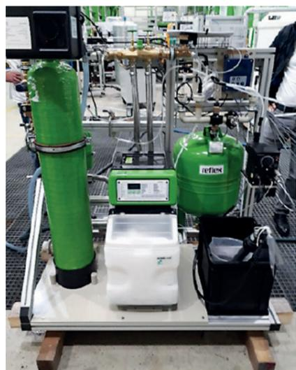
MCDI mit modifizierten Membranen und optionaler Vorbehandlungsstufen (Mehrschichtfilter, Aktivkohle, Enthärtung, Antiscalant Dosierung), Hersteller II (Quelle: BFI)
