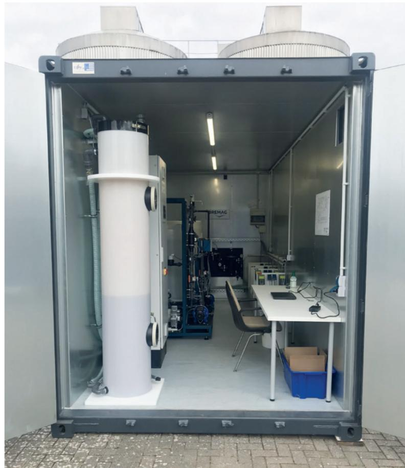
Pilotanlage zur Aufbereitung von Filterspülwasser mittels getauchter Polymere Membranen (Quelle: HAMBURG WASSER)
